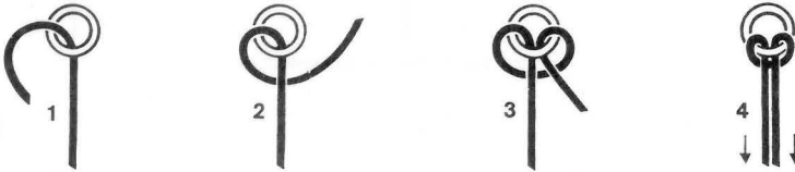
Binden des Doppelten Ankerstiches
